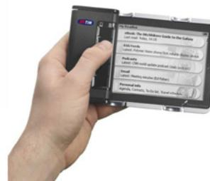
Такой «бумажный» дисплей способен отображать 16 оттенков серого (а учитывая успех Флепии, скоро он сможет быть и цветным), помимо этого сам девайс поддерживает GPRS, EDGE и DVB-H, а также позволяет работать до 10-ти дней без
